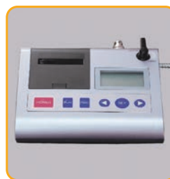
電気式ダイヤフラム式 自記圧力計
