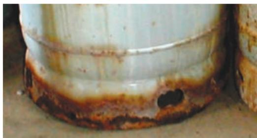
容器底部の腐食が激しい。
