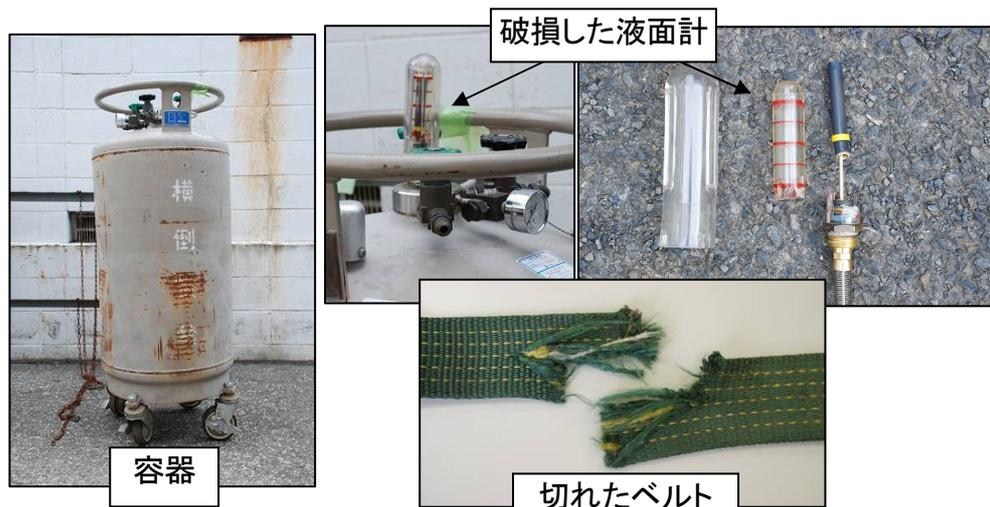
写真 1 破損した液面計及び切れたベルト
